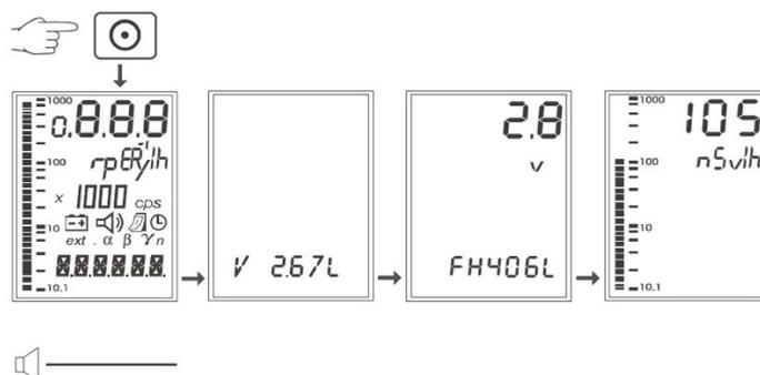
Figure 2 - Mise sous tension du radiamètre
